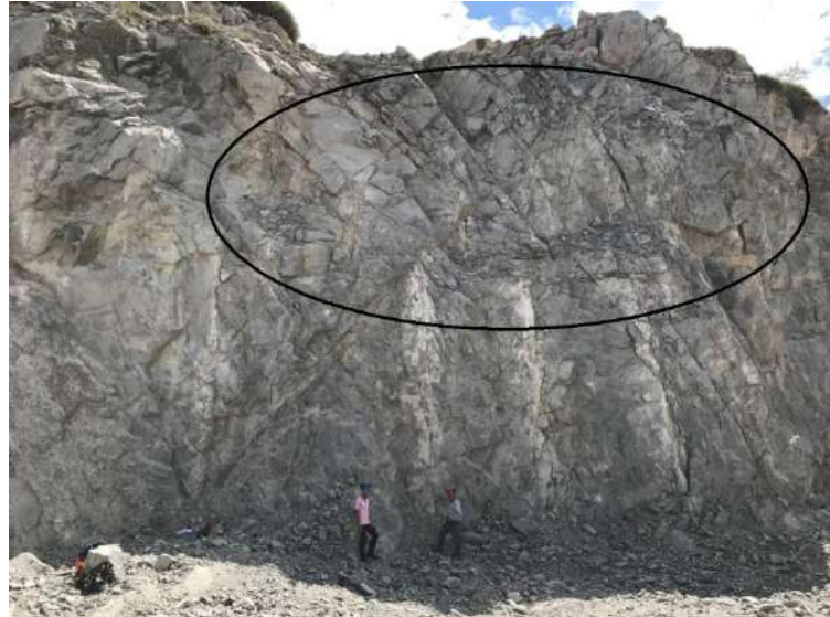
Figura 12- Blocos formados pelas descontinuidades.
